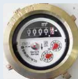
水道メーター
