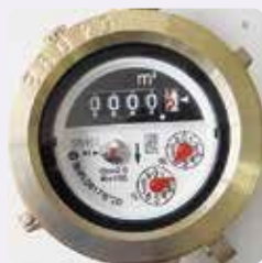
水道メーター
