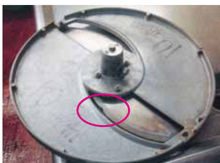
10ミリスライサーの刃の欠損部分 (幅約3cm、厚さ2～3ミリ)
